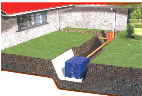
Widok na podstawowy segment indywidualnej neutralizacji deszczówki
